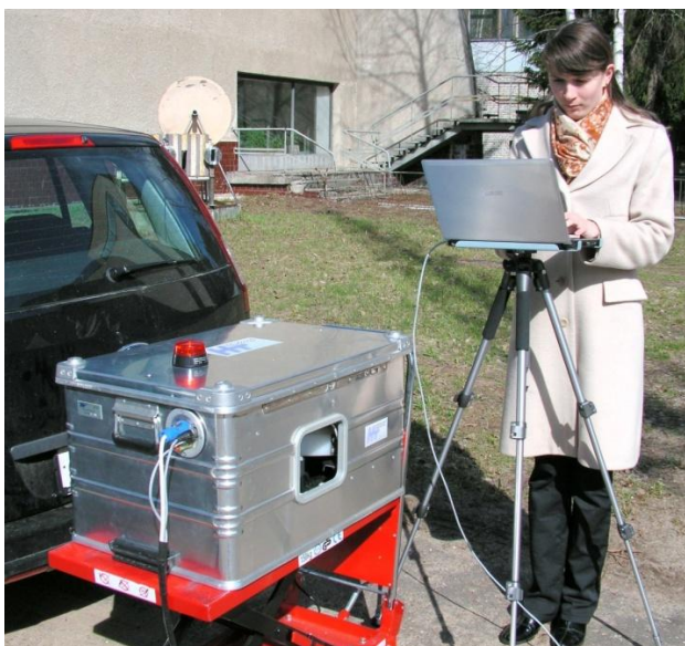
Компактный детектор наркотиков и взрывчатки, разработанный в рамках проекта ДВИН
