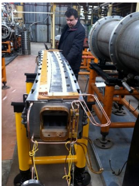
Сверхпроводящий изогнутый дипольный магнит бустера (слева) и двухапертурный дипольный магнит коллайдера
